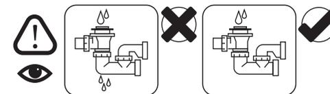
RU: По окончании монтажа проверьте работоспособность сифона. При выявлении подтеканий проверьте накрутку гаек и подтяните места соединений.
